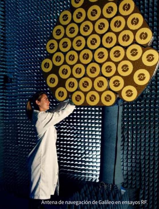
Antena de navegación de Galileo en ensayos RF.
